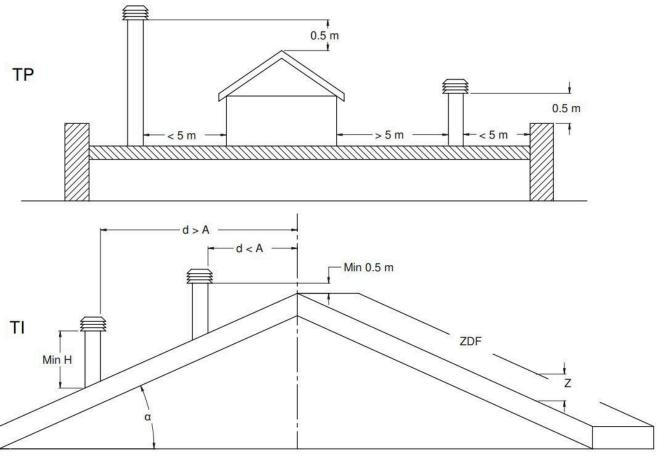
Legenda: TP - tetto piano; TI - tetto inclinato; d - distanza; ZDF - zona di reflusso
