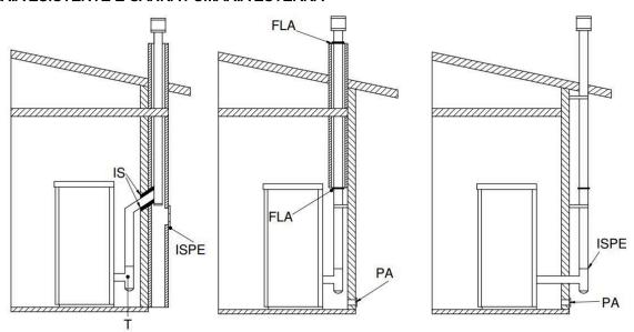
Legenda: IS - Isolante; ISPE - Ispezione; T - Raccordo a T; FLA - Flangia di chiusura ermetica; PA - Presa d'aria esterna
