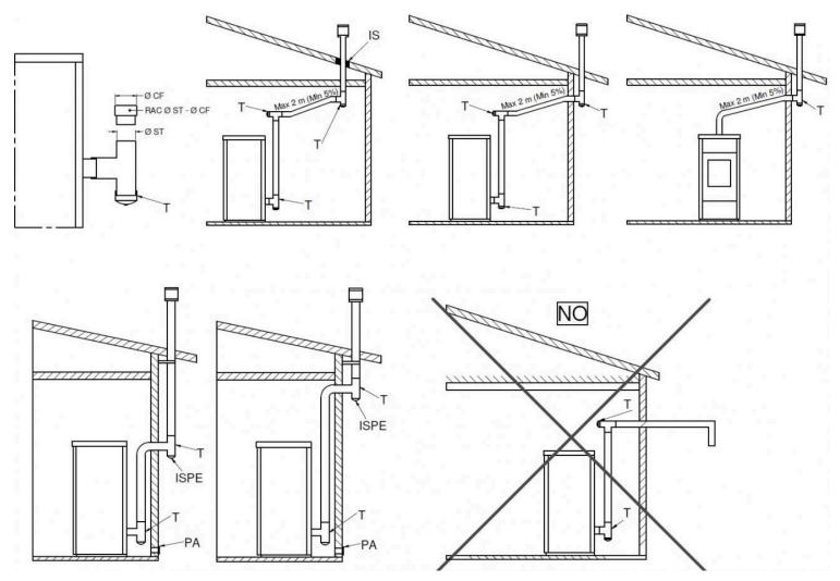
Legenda: T - Raccordo a T; Ø ST - Diametro T stufa; RAC Ø ST Ø CF - Raccordo stufa e canale da fumo; Ø CF - Diametro canale da fumo; IS - Isolante; ISPE - Ispezione; PA - Presa d'aria esterna
