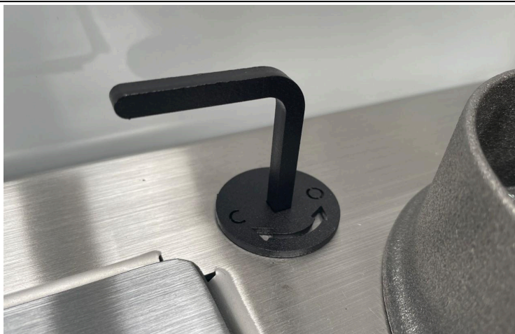
Registo de saída de fumo: rode a alavanca no sentido dos ponteiros do relógio para abrir o registo. Mantenha-o fechado durante o funcionamento normal.
