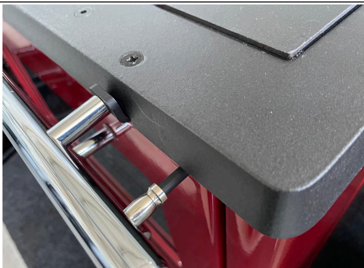
Registo de saída de fumos: fechado quando a alavanca é empurrada dentro da salamandra. Aberto no momento em que se extrai a alavanca.
