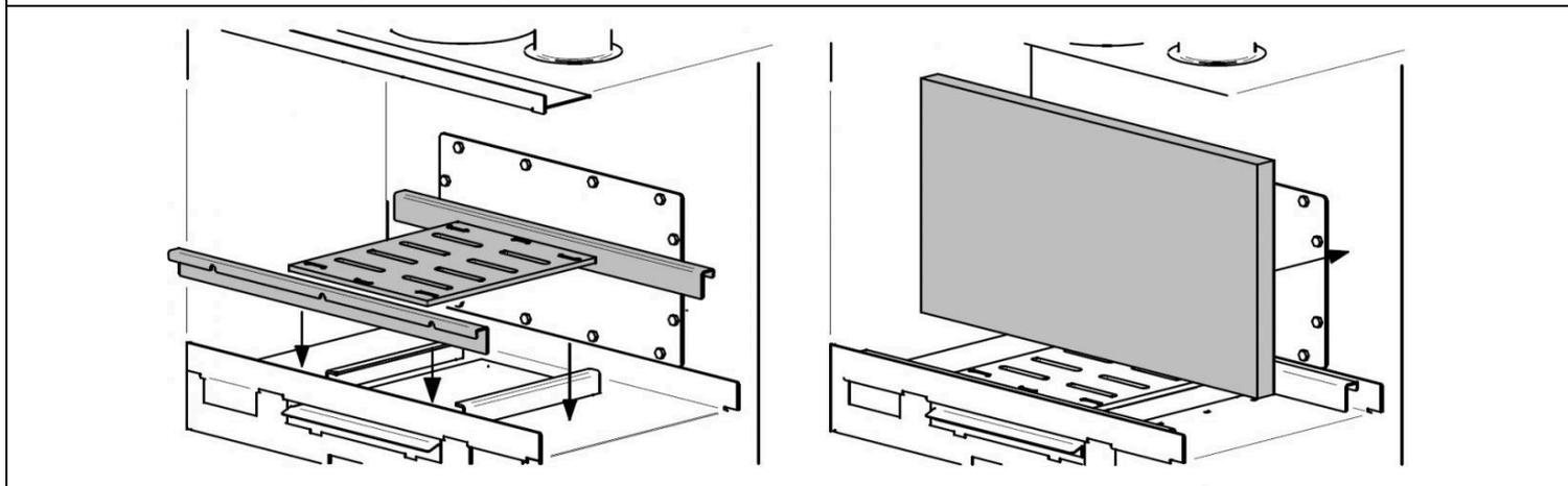
2. Coloque as vermiculites laterais e empurre-as para trás.
