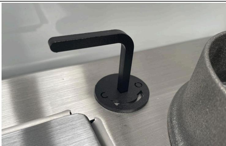
Registro de salida de humos: gire la palanca en el sentido de las agujas del reloj para abrir el registro. Manténgalo cerrado durante el funcionamiento normal.
