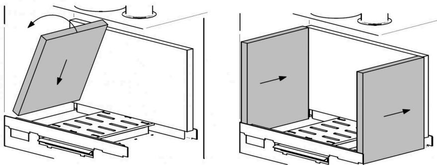
3. Positionner le déflecteur supérieur, installer les « C » de renfort. Contrôler les enclenchements et une fois positionné, poussez-le vers l'arrière.
