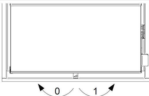
Registre d'air : avec ce registre, il est possible de régler l'allumage et la combustion du produit.
