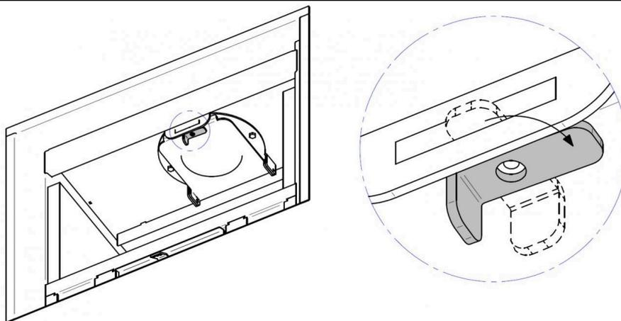
2. Tourner le déflecteur et insérer d'abord le turboréacteur puis le filtre catalytique. Refermer ensuite le levier pour verrouiller le déflecteur.
