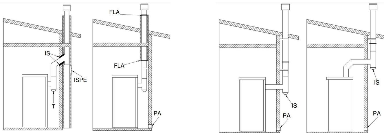
Légende : IS - Isolant ; INSPECTION - Inspection ; T - Raccord en T ; FLA - Bride de fermeture hermétique ; PA - Prise d'air extérieure
