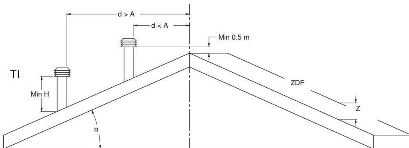
Légende : TP - toit plat ; TI - toit incliné ; d - distance ; ZDF - zone de reflux
