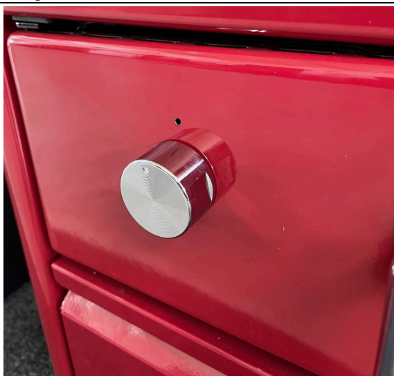
Registro aria primaria. Chiuso in questa posizione
