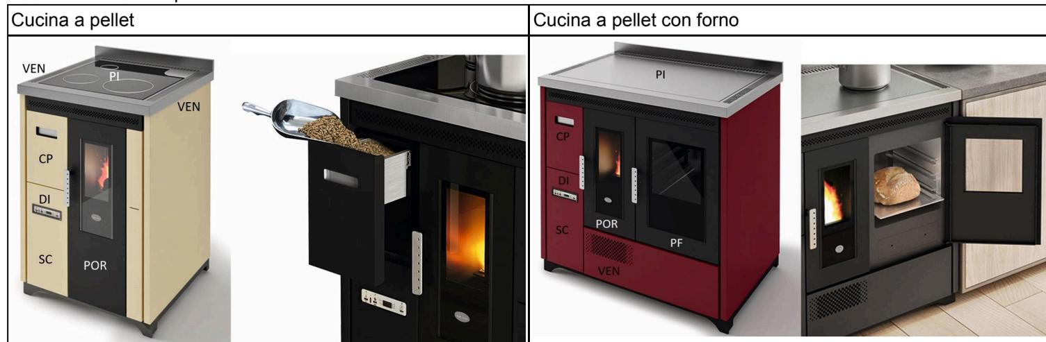
Legenda: VEN: uscita aria ventilazione; PI: Piastra superiore in acciaio o vetro ceramizzato (solo versione senza forno); CP: cassetto estraibile pellet; DI: display; POR: porta focolare; PF: porta forno; SC: sportello inferiore (troverete interruttore ON/OFF, Termostato di sicurezza, Presa RS232).
