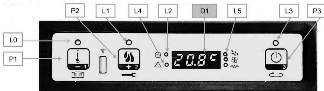
L'unità console permette di colloquiare con il controllore con la semplice pressione di alcuni tasti. Un display e degli indicatori a LED informano l'operatore sullo stato operativo della stufa. In modalità programmazione sono visualizzati i vari parametri che possono essere modificati agendo sui tasti.
