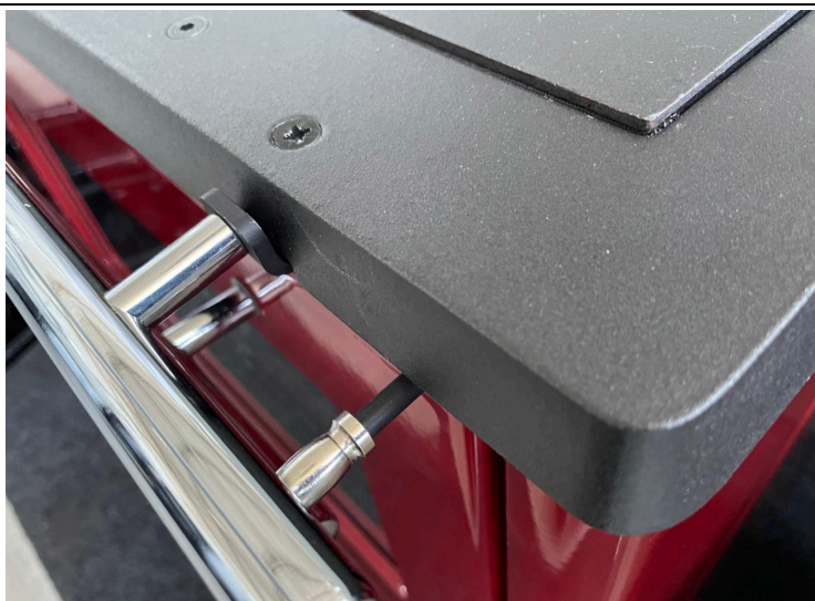
Registre de sortie des fumées : fermé lorsque le levier est poussé vers l'intérieur du poêle. Ouvert lorsque le levier est extrait vers l'extérieur.
